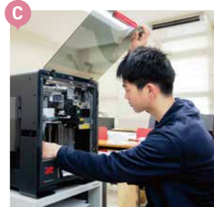
C 3Dプリンタ／パソコン上で作成した3Dデータを元に、3次元の立体的なオブジェクトを造形する装置です。主にプロダクトデザインの試作品や雛型をつくる用途に使われます。
