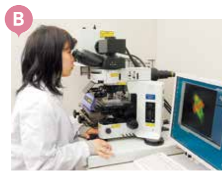
B レーザー顕微鏡／普通の顕微鏡に比べ分解能が高いレーザー顕微鏡です。生物の細胞のなかや、断面だけでなく3D画像を見ることが可能で、バイオ系の研究には欠かせない装置です。
