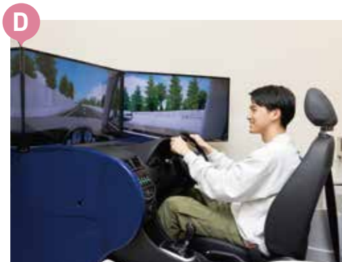
D ドライビングシミュレータ／3画面モニターおよび実車同様の運転席からなるドライビングシミュレータです。さまざまな交通状況をリアルに再現することが可能で、運転行動の理解に活用しています。
