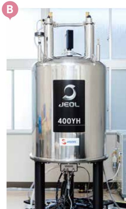
B 超伝導NMR／人体の断層撮影を行うMRIと同じ原理の機器です。超伝導磁石がつくる強力磁場を使って、機能性物質や生体分子の構造を原子レベルで解析します。
