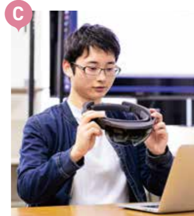
C ARヘッドマウントディスプレイ／実世界に3DCGモデルを投影して見ることができる装置です。建物や家具の配置、家電の使用説明など、さまざまな分野に応用できます。
