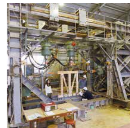
大型耐震実験装置／実際の建物と同じ鉄筋を組み上げ、縦横に強い力を加えて、壊れ方を観察・分析するための装置です。
