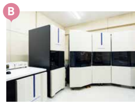
B X線光電子分光装置(XPS)／電池や太陽光発電などの性能を左右する物質中の電子の状態を知ることができる装置です。
