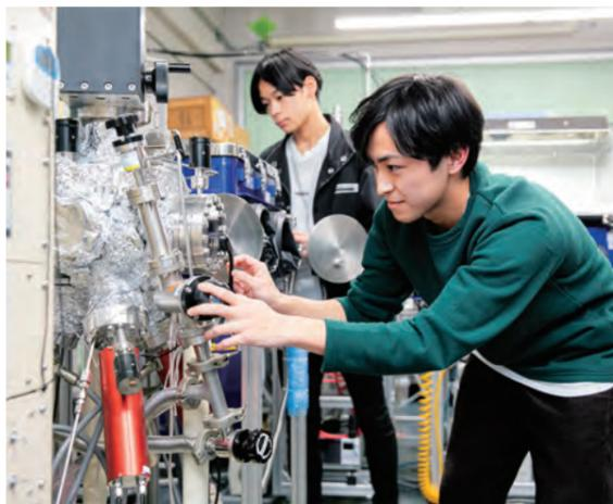
薄膜技術を用いた電池電極材料の作製
