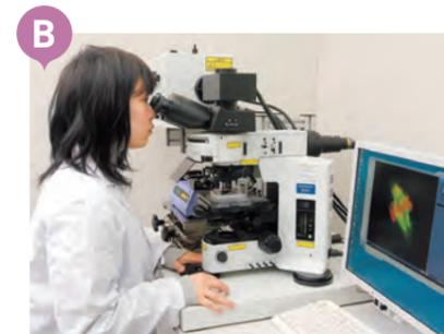
**B** レーザー顕微鏡 / 普通の顕微鏡に比べ分解能が高いレーザー顕微鏡です。生物の細胞のなかや、断面だけでなく3D画像を見ることも可能で、バイオ系の研究には欠かせない装置です。
