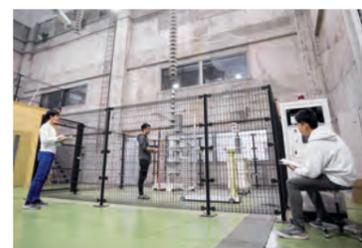
**C** 高電圧実験室 / 電気工学の分野のなかで、とくに高い電圧が加わる所に起きる電気現象について学ぶ施設です。
