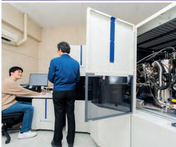
光電子分光装置による材料評価
