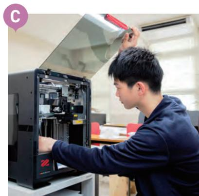
**C** 3Dプリンタ / パソコン上で作成した3Dデータを元に、3次元の立体的なオブジェクトを造形する装置です。主にプロダクトデザインの試作品や雛型をつくる用途に使われます。
