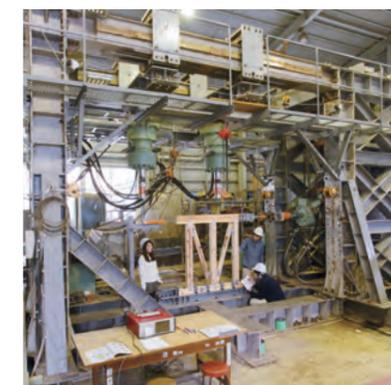
**C** 大型耐震実験装置 / 実際の建物と同じ鉄筋を組み上げ、縦横に強い力を加えて、壊れ方を観察・分析するための装置です。
