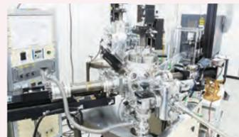
レーザーを用いたハイドロキシアパタイト薄膜を作製する技術によって、次世代のインプラント(人工骨・人工関節など)に必要な生体適合性の付与技術の研究・開発を行います。
