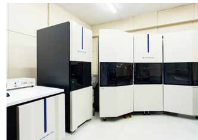
X線光電子分光装置(XPS) ／電池や太陽光発電などの性能を左右する物質中の電子の状態を知ることができる装置です。
