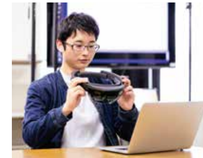
ARヘッドマウントディスプレイ ／実世界に3DCGモデルを投影して見ることができる装置です。建物や家具の配置、家電の使用説明など、さまざまな分野に応用できます。
