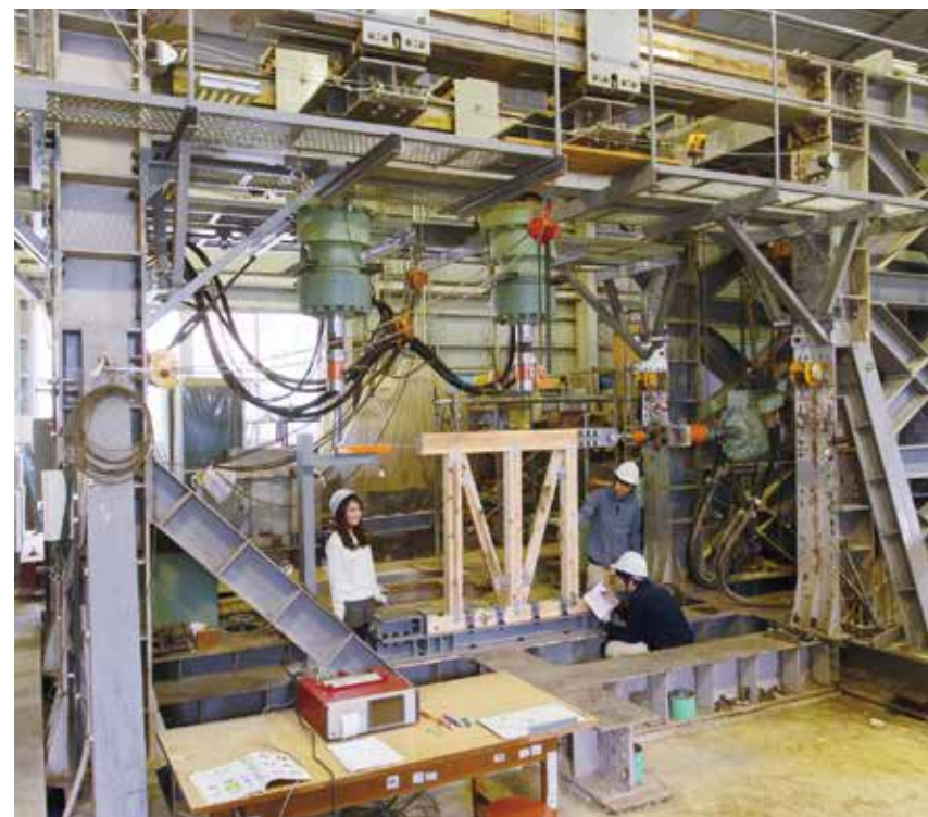
大型耐震実験装置 ／実際の建物と同じ鉄筋を組み上げ、縦横に強い力を加えて、壊れ方を観察・分析するための装置です。
