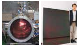
研究室内で太陽電池用の薄膜を作成(左) 製品化された薄膜太陽電池(右)
