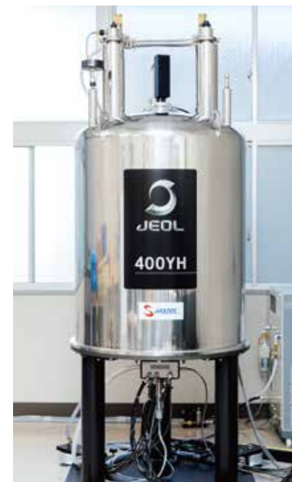
超伝導NMR ／人体の断層撮影を行うMRIと同じ原理の機器です。超伝導磁石がつくる強力磁場を使って、機能性物質や生体分子の構造を原子レベルで解析します。
