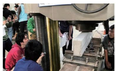
コンクリートの強度測定や鋼材の引張試験など、素材の特性を実地で学ぶことができる講義。素材が固まつたとき、柔らかいたきの違いなどを知り、施工のための知識を身につけます。
