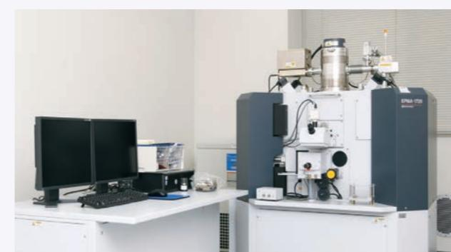
**EPMA電子線マイクロアナライザ** / 物質がどんな元素から構成されているのかを、その物質に電子線を当て、その表面に含まれる元素の種類や分布状態、含有量の解析を行う装置です。
