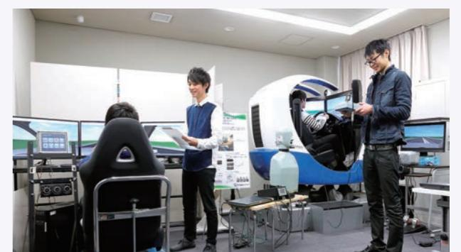
**ドライビング・シミュレータ** / 自動車など、さまざまな乗り物の快適性や安全性に関する研究開発を行うため、全身振動や加速度の測定を行う装置です。
