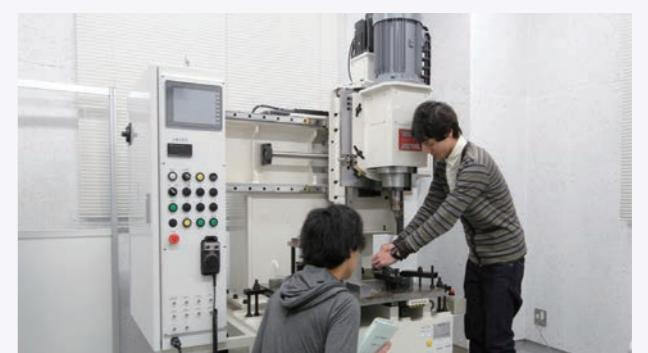
**摩擦攪拌接合機** / 金属の表面を回転による摩擦の熱で2つの金属を接合させる装置。ネジなどを減らすことにより、自動車の軽量化が期待できます。
