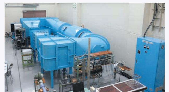
**可変風速型風洞実験装置** / 自動車などの模型の周りに、台風並みの突風や変動風を人工的に発生させ、模型に働く力や風の流れを計測できる装置です。
