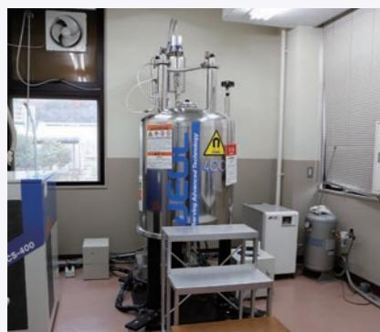
**超伝導核磁気共鳴(NMR)装置 / 有機化合物の分子構造、原子の結合状態などを調べることができます。分析装置です。**
