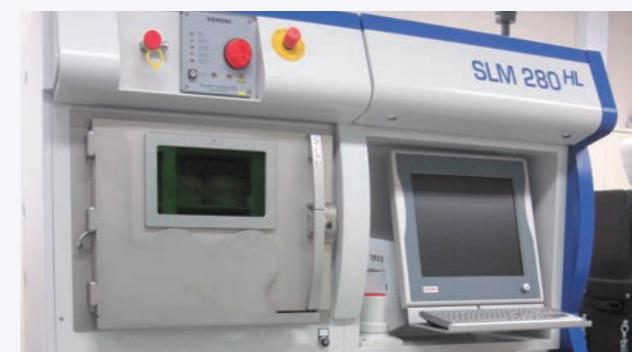
**金属3Dプリンタ金属粉末レーザー積層造形装置** / 国内では数少ない高出力の3次元の金属造形物を製造する装置。航空宇宙をはじめ、多くの分野から注目されています。
